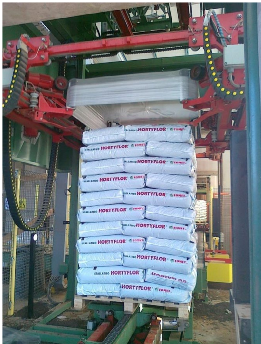
Sistema automatizzato di filmatura pallett
